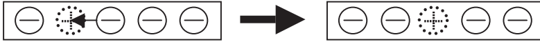
Figura 5.1. Un hueco (el círculo de puntos) se mueve hacia la derecha, del segundo lugar al tercer lugar en la fila; mientras que, equivalentemente, un electrón se mueve hacia la izquierda, del tercer lugar al segundo lugar.
