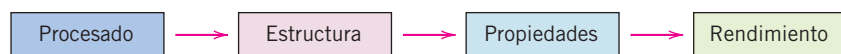
Figura 1.1 Los cuatro componentes de la disciplina de la ciencia e ingeniería de materiales y su interrelación.
