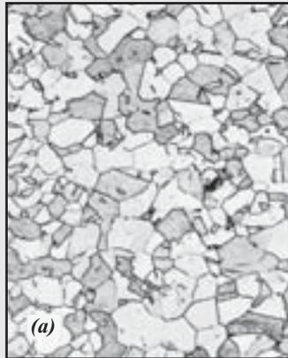
La fotografía de la Figura (b) es una preforma de envase de aluminio para refrescos. La fotografía de la Figura (a) reproduce la microestructura de este aluminio: los granos son equiaxiales; es decir, tienen aproximadamente la misma dimensión en todas las direcciones.
