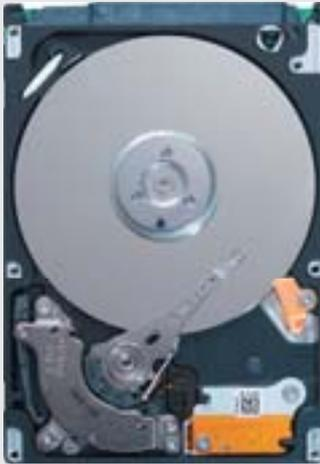
(c) Interior de una unidad de disco duro. El disco circular gira normalmente a una velocidad de 5400 o 7200 rpm.
