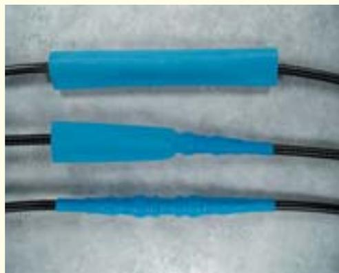
Arriba: Protección de una conexión eléctrica mediante retractilidad (*shring-wrap*). Centro y abajo: Al aplicar calor al tubo el diámetro se reduce y con esta contracción, el tubo de polímero estabiliza la conexión y proporciona aislamiento eléctrico. (Fotografía cortesía de Insulation Products Corporation).
