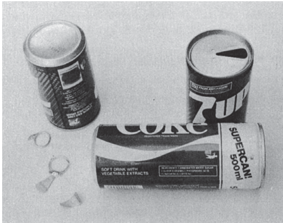
Figura 1.5 La lata de aluminio es un producto innovador. El cuerpo está hecho a partir de una única pieza de una aleación de aluminio de la serie 3000. La parte superior de la lata es una pieza prensada que se fija al cuerpo una vez que la lata se ha llenado. Hay limitaciones para la construcción en una sola pieza.
